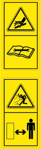
Ne jamais colmater manuellement une fuite sur un flexible hydraulique. Risque de blessure très grave. Consulter le manuel technique pour les opérations de maintenance.
