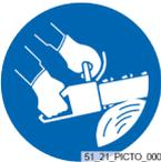
Die Säge muss immer mit beiden Händen gehalten werden. Halten Sie die Säge immer mit der linken Hand am Führungsgriff fest.
