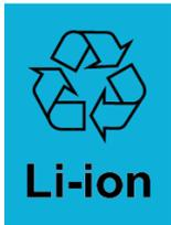
Simbolo di marcatura per l'identificazione della caratteristica chimica della batteria ai fini del riciclo.
