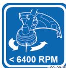
Controllare obbligatoriamente la direzione e la velocità di rotazione del testa di taglio.
