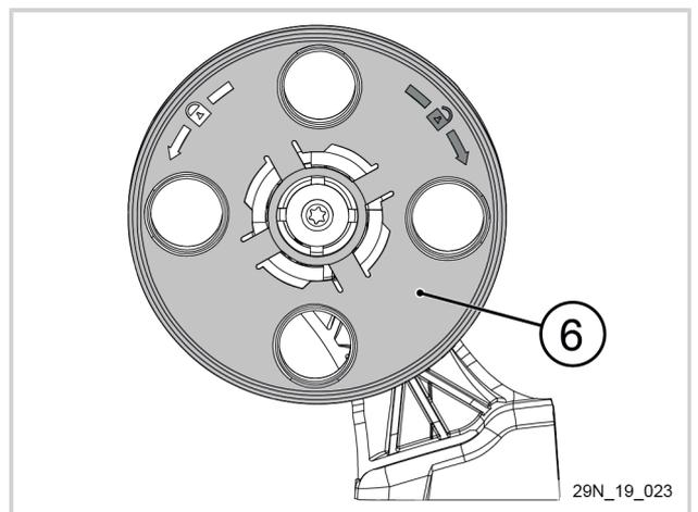
3. Mettre en place la bobine sur le moyeu du dévidoir adaptable (6).
