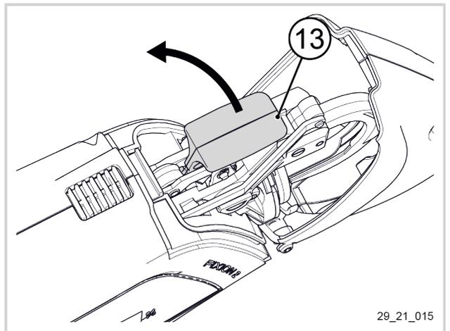
3. Insérer le guide supérieur neuf (13) en butée, sous le galet d'appui.
