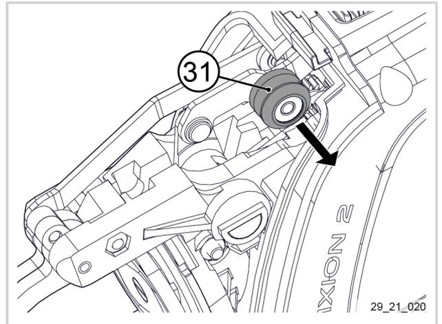
7. Mettre en place le galet d'appui (31) neuf.
