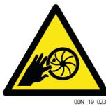
Nicht die Finger oder Gegenstände in das Ansauggitter einführen. Wenn das Ansauggitter nicht eingebaut ist, besteht die Gefahr, mit den rotierenden Teilen in Berührung zu kommen. Verletzungsgefahr! Gefahr der Beschädigung der rotierenden Bauteile.
