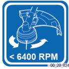
Vorgeschriebene Überprüfung der Drehrichtung und der Drehzahl des Schneidkopfes.
