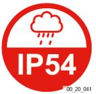
Schutzart des Geräts in der Arbeitsposition mit Akku oder Gegengewicht: IP54 (Schutz gegen Staub und Spritzwasser).
