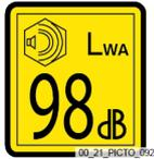
Garantierter Schalleistungspegel LwA
