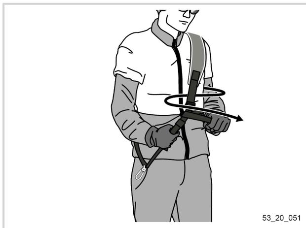
5. Desserrer légèrement la vis Torx de l'œillet de portage qui est sur le tube de l'outil.
