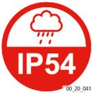
Indice de protection IP54 de l'outil en position de travail avec batterie ou contrepoids (Protection contre les poussières et les projections d'eau dans toutes les directions).
