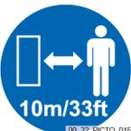
Distancia de seguridad que se debe mantener Manténgase alejado a más de 10 metros del área de trabajo de la máquina.
