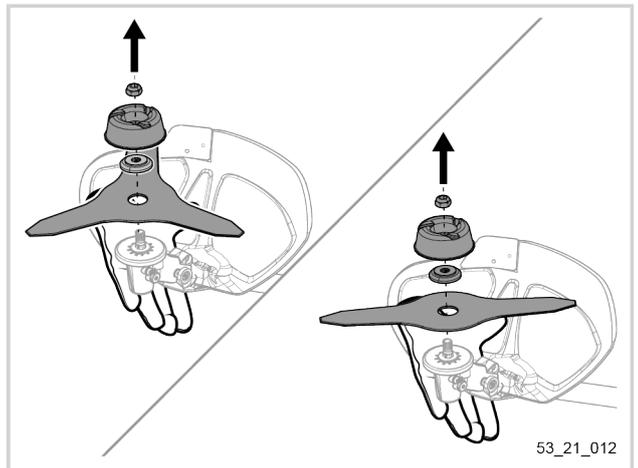
**4.4.2. FITTING/DISMOUNTING THE MULCHING BLADE ON THE TOOL**
