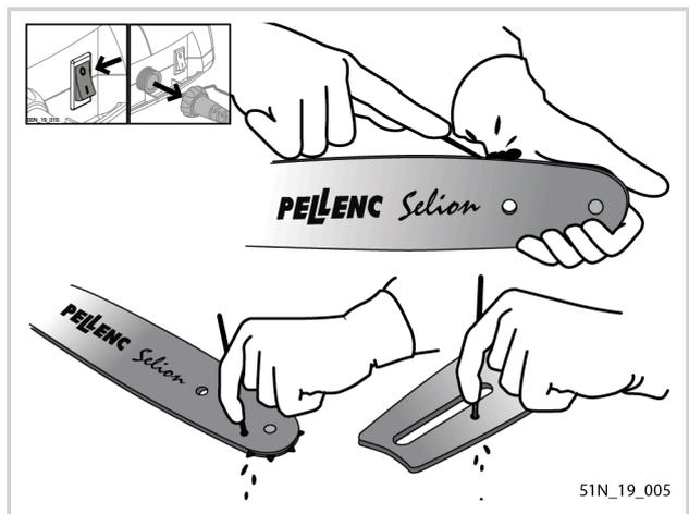
**6.11. DIE RÜCKSCHLAGSCHUTZ-KETTENFÜHRUNG SCHMIEREN**
