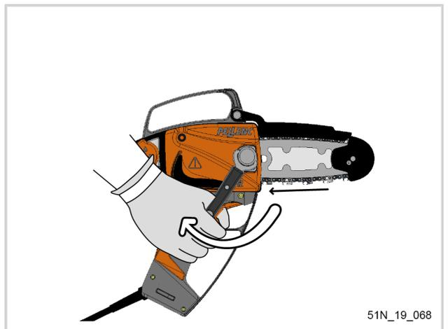
3. Den Griff des Teleskopschlüssels (11) auf seinem Haltemagneten positionieren.
