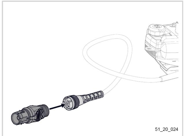
4. Schnellverbinder-Adapter an das Adapterkabel anschließen.
