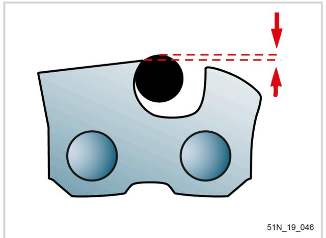
3. Die Schneidzähne auf der einen Kettenseite schärfen, indem von innen nach außen gefeilt wird. Die Feile darf nur im Vorwärtsstrich greifen.
