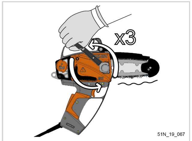
2. Die Klemmmutter (8) mit dem Teleskopschlüssel (11) wieder festschrauben. Dadurch bewegt sich die Kettenführung (7) nach vorn und spannt automatisch die Kette (6).
