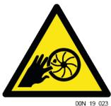
Finger oder jede Art von Gegenständen nicht in das Ansauggitter einführen. Wenn das Ansauggitter nicht eingebaut ist, besteht die Gefahr, mit den rotierenden Teilen in Berührung zu kommen. Verletzungsgefahr ! Gefahr der Beschädigung der rotierenden Bauteile.
