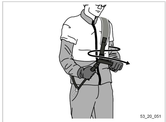
5. Montare l'occhiello di trasporto sul tubo dell'utensile.
