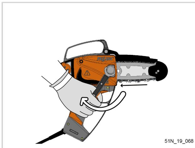
3. Colocar la palanca con la llave telescópica (11) en el imán adherente.
