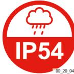
Índice de protección IP54 de la herramienta en posición de trabajo con batería o contrapeso (protección contra el polvo y las salpicaduras de agua en todas direcciones)
