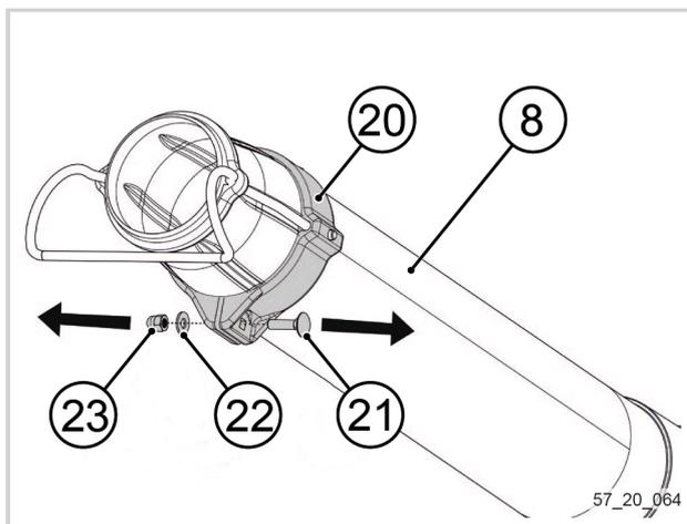
2. Déposer l'ensemble de la tuyère de sortie (8).
