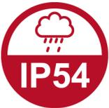
Schutzart des Geräts IP54 (Schutz gegen Staub und Spritzwasser)
