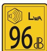
Garantierter Schalleistungspegel LwA
