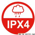
Grado de protección IPX4: el producto es apto para todo tipo de condiciones meteorológicas y es resistente a las salpicaduras de agua fuertes. Sin embargo, no resiste la inmersión.
