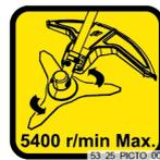
Drehrichtung und maximale Drehzahl (5.400 U/min).
