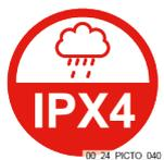
Schutzart IPX4: Das Produkt ist für sämtliche Witterungsbedingungen geeignet und weist eine hohe Beständigkeit gegen Spritzwasser auf. Er ist jedoch nicht wasserdicht.
