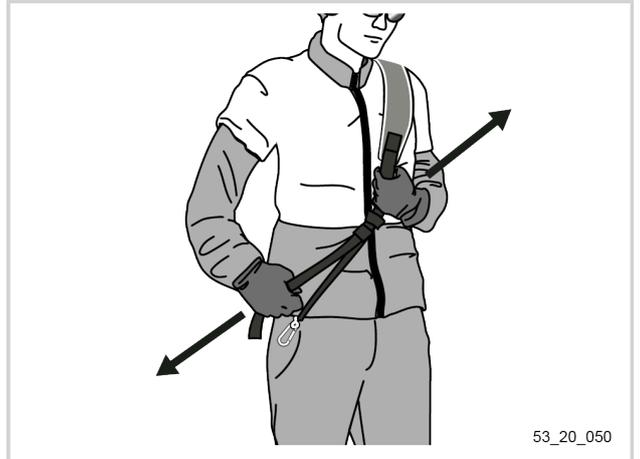
3. Das Tragegurtende mit dem Klettverschluss unter den Hauptgurt positionieren.
