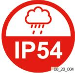
Indice di protezione IP54 dell'utensile (Protezione contro la polvere e gli spruzzi d'acqua da tutte le direzioni): non riguarda la batteria.
