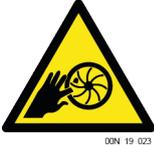
Non introdurre le dita o qualsiasi altro oggetto nella griglia di aspirazione dell'aria. Se la griglia d'aspirazione non è montata, rischio di contatto con componenti in rotazione e rischio di lesioni!
