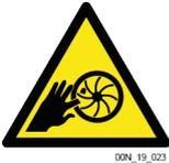
No introducir los dedos ni ninguna clase de objeto en la rejilla de entrada del aire. Cuando la rejilla de admisión no esté montada, existe el riesgo de contacto con las piezas en rotación - riesgo de sufrir lesiones. - riesgo de dañar los elementos giratorios.
