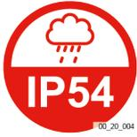
Indice di protezione IP54 dell'utensile (Protezione contro la polvere e gli spruzzi d'acqua da tutte le direzioni), non riguarda la batteria.
