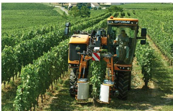
Der Entlauber für eine komplette Zeile kann ebenfalls am OPTIMUM-Trägerfahrzeug befestigt werden.
