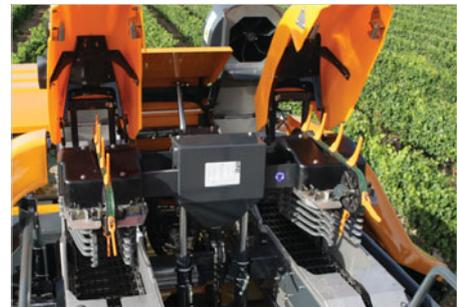
Abbeermaschinen mit Synchronantrieb
