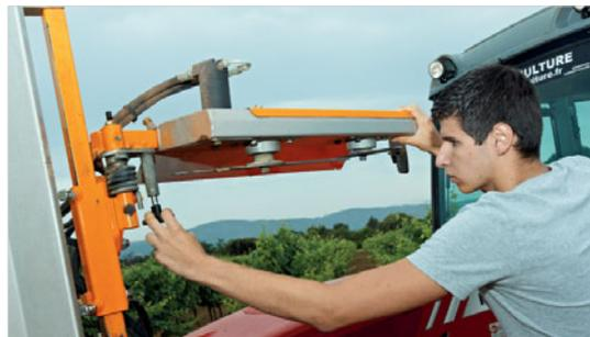
Werkzeugloses Einklappen der horizontalen Schneidwerke für den sicheren, schnellen Straßentransport.
