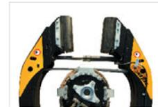
Schützt die junge Baumrinde durch die automatische Anpassung der Klemmkraft des Greifers.
