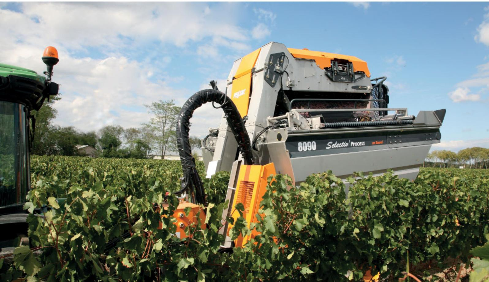
*„Wir haben uns für die Anhängemaschine 8090 Selectiv' Process entschieden, da die Investition im Vergleich zu einem Selbstfahrer nur halb so groß ist. Wir sparen mit der Maschine 60 % Kraftstoff, was bei der von uns bewirtschafteten Fläche von 120 Hektar in etwa 8.000 € pro Jahr entspricht. Auch die Wartungskosten konnten wir so um 80 % im Vergleich zum Selbstfahrer der Konkurrenz, den wir vorher hatten, senken.“*
