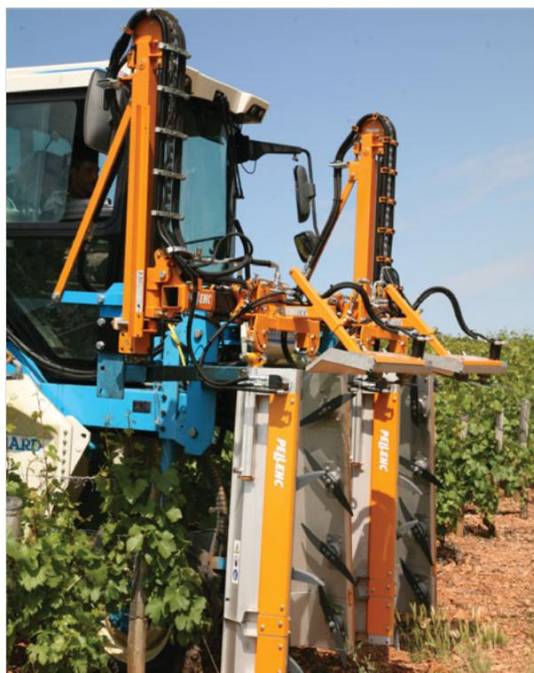
MULTIVITI-Überzeilenrahmen, zweizeilig, mit hydraulischem Laubschneider
