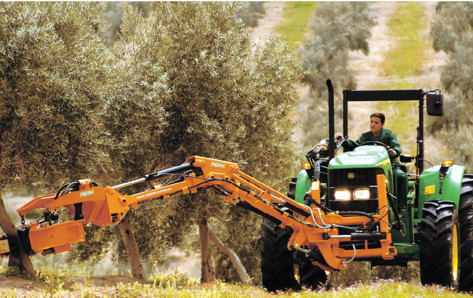
*„Wir besitzen den BAUMSCHÜTTLER F100 seit zwei Jahren und sind sehr zufrieden mit seiner Leistung. Durch den Dreipunkt-Greifer mit der hohen Klemmkraft sind die Vibrationen des F100 besonders effektiv, sodass weniger Zeit pro Baum benötigt wird. Die Erntekosten werden deutlich gesenkt (Personalkosten um 50 % im Vergleich zur Ernte von Hand). Auch Zeitdruck und Erntebelastung werden abgemildert, ich kann die optimalen Tage für die Ernte auswählen und bei Frost schnell reagieren.“*
