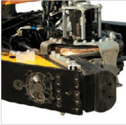
Zur ständigen Kühlung der Schutzbeläge des Greifers, die sich bei intensiver Verwendung erhitzen.
