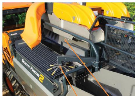
Vibrationselement und Drehverteiler am Sortiertisch.
