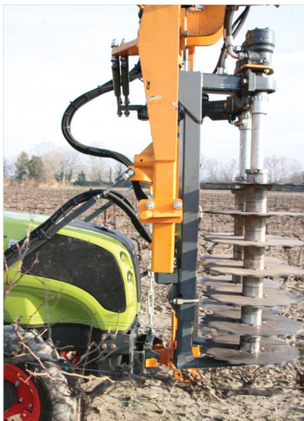
*Präzise Abstandseinstellung zwischen den Schneidscheiben für einen glatten Schnitt*
