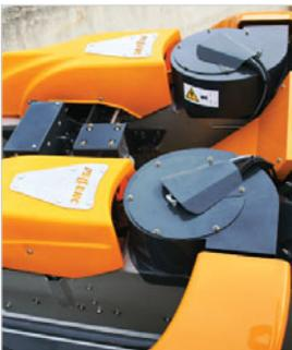
Leistung der (optional erhältlichen) oberen Absauger einstellbar, zu Reinigungszwecken einfahrbar
