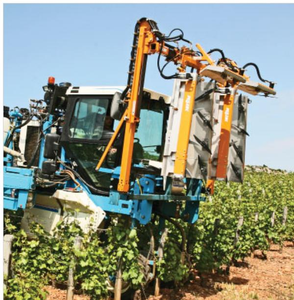
*Vertikales Anheben der Schneidwerke*
