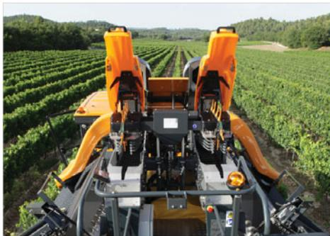
Schnellabkopplung über die EASY-TOUCH-Konsole von Abbeermaschinen, oberen Absaugern und Sortiertischen.
