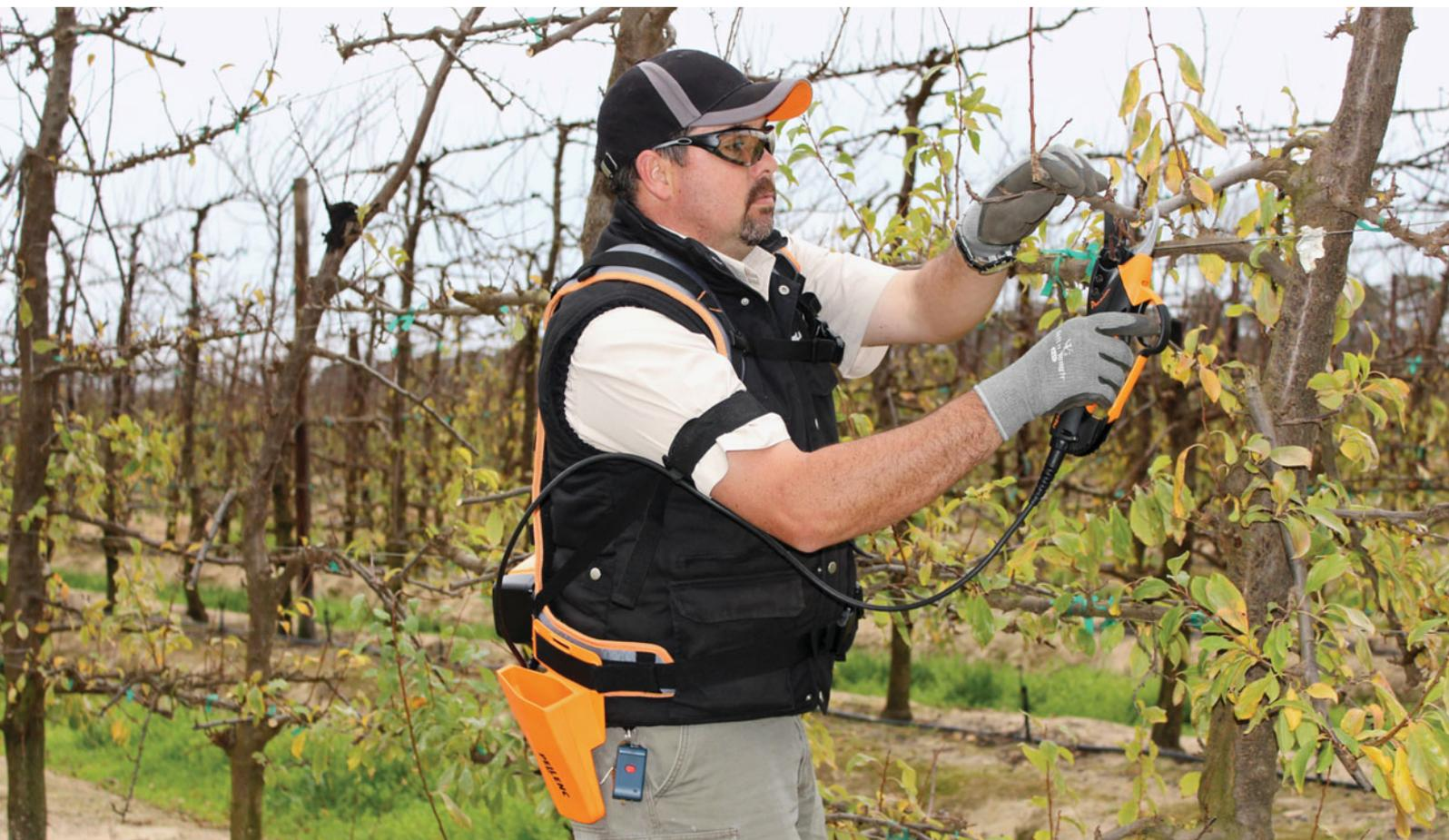
*„Die Baumschere Prunion schneidet auch größere Durchmesser von 40 mm bis 45 mm und die Handhabung ist wesentlich komfortabler als die einer mechanischen Baumschere. Der Akku ist super leicht, man spürt ihn fast gar nicht.“*
